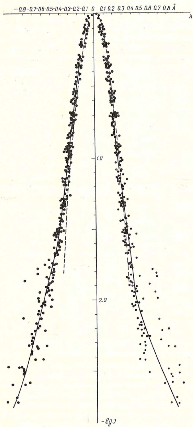
Фиг. 3. Результаты измерения инструментального контура красной камеры для ширины щели от одной до двух нормальных. Пунктиром указан доплеровский контур
